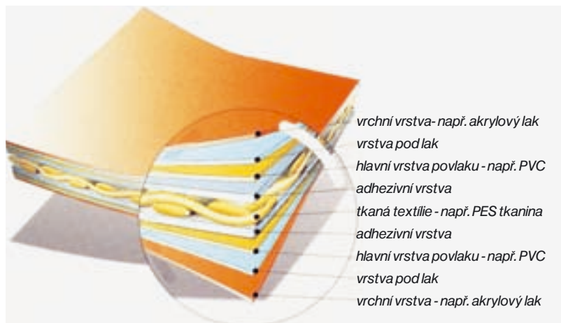
Příklad složení tkané membrány se zátěrem a lakem (Valmex, HAKU Mehler).
